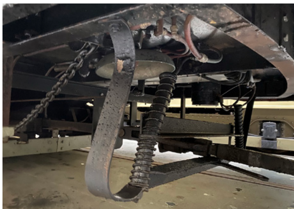
Het verwrongen koppelraam onder de A 106.
