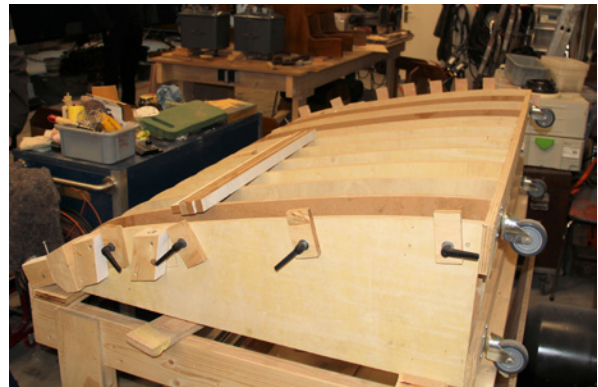
Hulpstuk (mal) voor het vormen van de plafondplaten.
