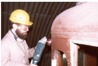
Peter van den Oever actief met de slijptol. Georg Groenveld aan het ontroesten. Han Geijp last een nieuwe plaat op het dak.
