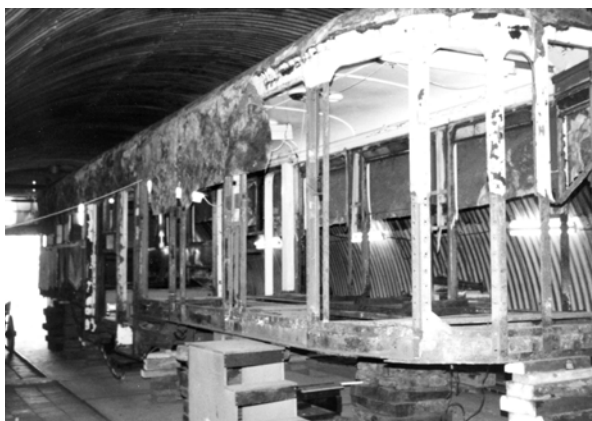
De reeds ontmantelde rijtuigbak, ook het dakinnen moest worden verwijderd.
