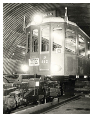
Nog even en de draaistellen worden onder de B 412 gereden..
