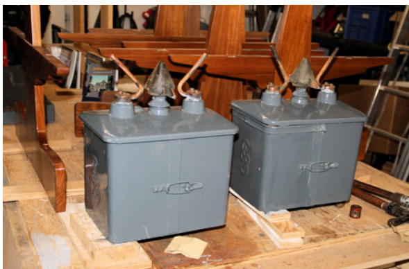
Maximaal automaten, klaar voor montage op het dak.
