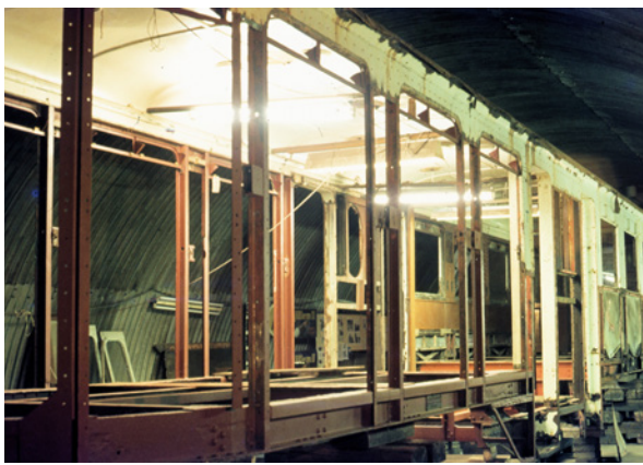
De beplating is weggenomen en raamstijlen al deels vervangen. Altijd veel belangstelling tijdens de jaarlijkse Open Dagen.
